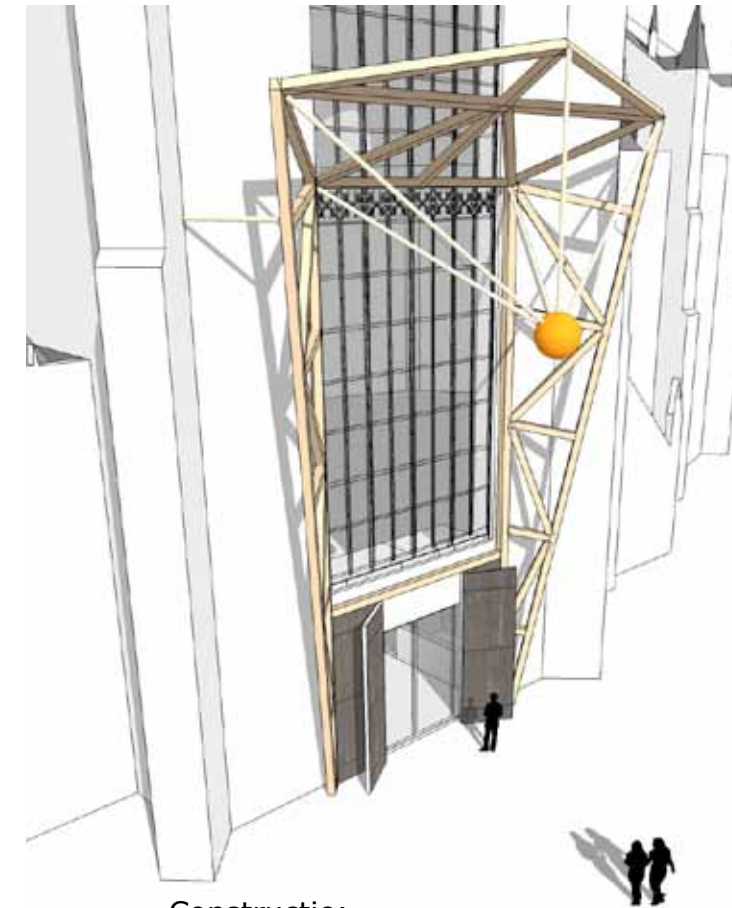
Constructie: stalen frame als drager voor bekleding
